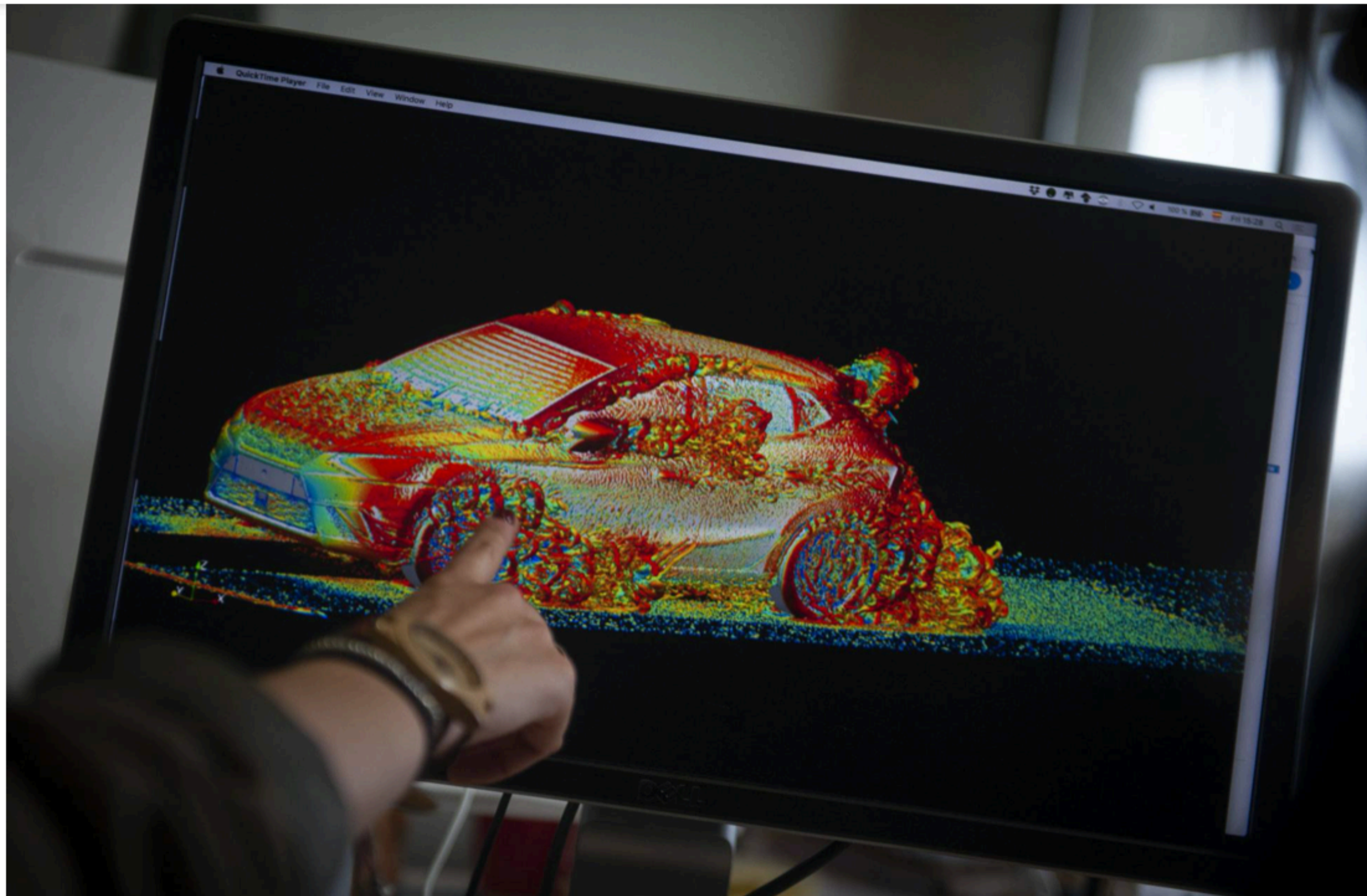
Simulación de la aerodinámica de un coche de Seat en el BSC. JUAN BARBOSA
